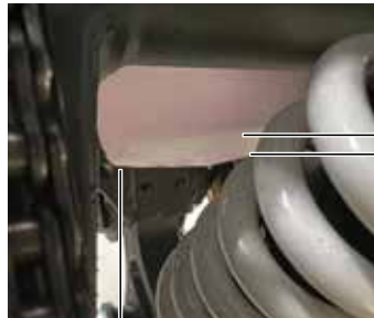
Serbatoio liquido refrigerante
