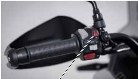
Segnalazione di emergenza "Hazard"
