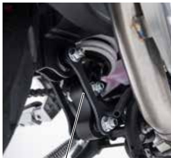
Ammortizzatore posteriore a leveraggio progressivo
