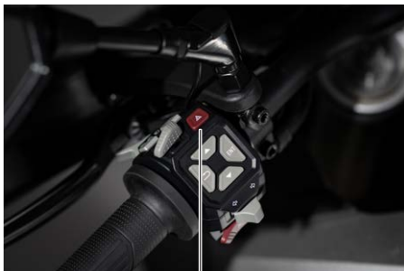
Segnalazione di emergenza "Hazard"
