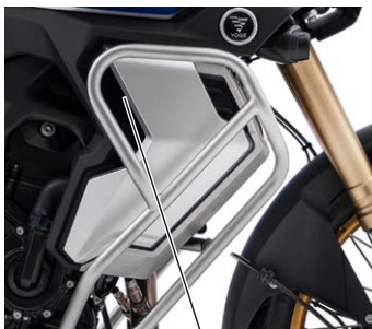
Serbatoio liquido refrigerante
