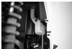
Localizzazione serbatoio liquido refrigerante
