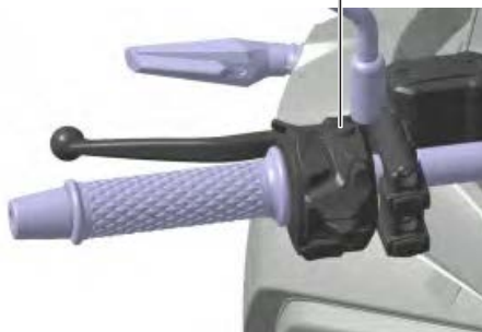
Segnalazione di emergenza (HAZARD)
