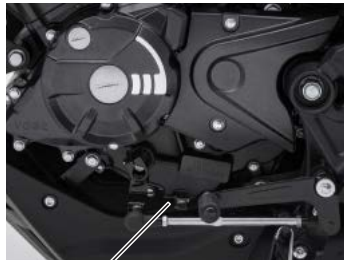
Vite di drenaggio (lato sinistro)
