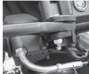
Controdado (3) Vite di regolazione (2)
