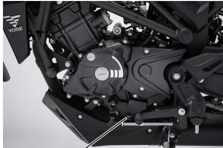
Vite di drenaggio
