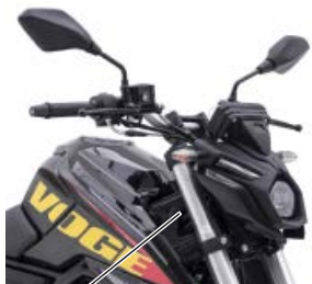
Serbatoio liquido refrigerante
