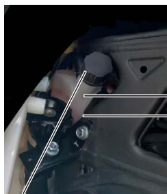
Tappo serbatoio liquido refrigerante
